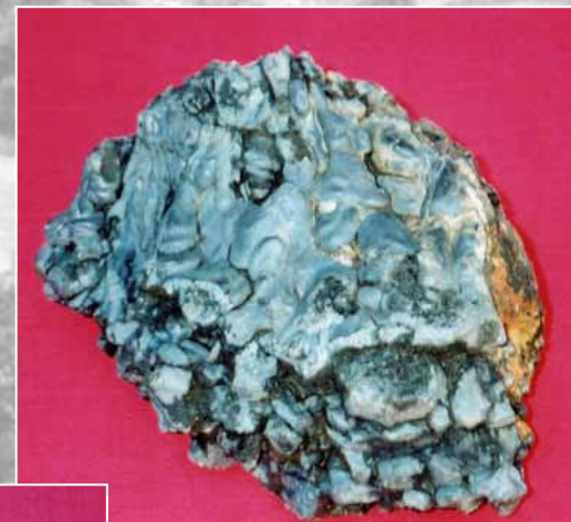
Déchets métallurgiques produits par des bas- fourneaux de réduction
