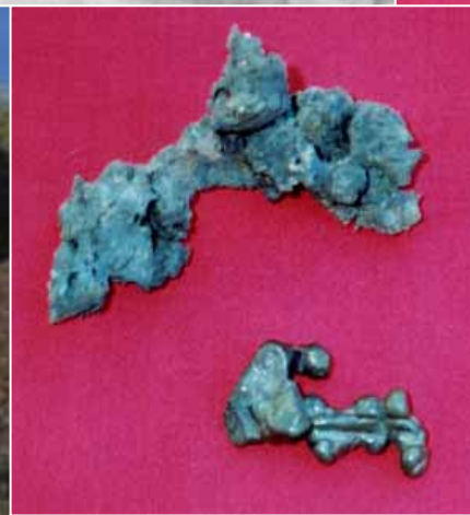
Déchets métallurgiques produits par des bas- fourneaux de réduction
